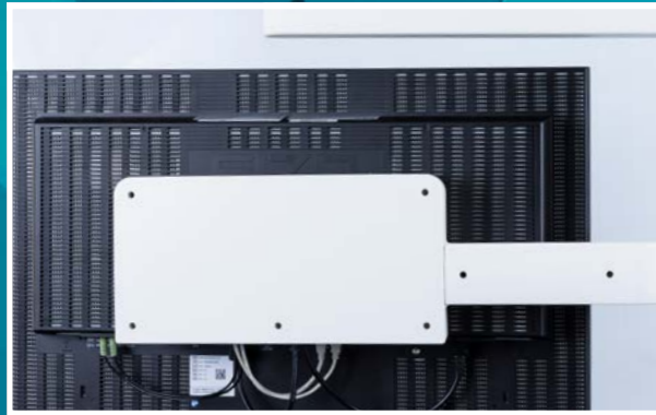
Gehäuse für Netzteil und Kabel / Covered Housing for power supply and cables
