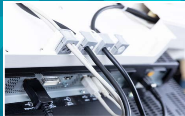
Zugentlastung für gängige Kabel-Ø / Pull relief for common cable diameters
